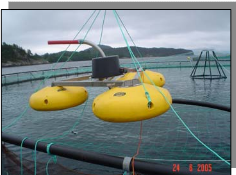
Fôrspreder med ny flottør design
