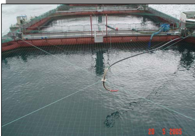
Fôrspredere med oppheng for sentralfôring
